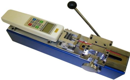
Dinamometro digitale che consente di effettuare test di resistenza allo sfilamento di cavi elettrici aggraffati.
