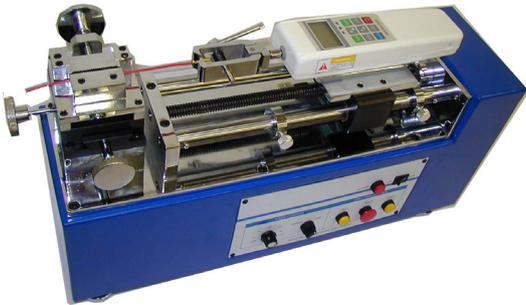
Dinamometro digitale motorizzato che consente di effettuare test di resistenza allo sfilamento di cavi elettrici aggraffati.
