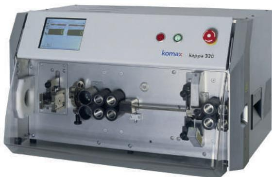
Macchina automatica per il taglio e la spelatura di cavi da 0,22 a 35 mm<sup>2</sup> e conduttori multipolari fino a diametro esterno 16 mm e spelatura conduttori interni fino a 4x1mm<sup>2</sup> così come per cavi piatti fino a 40 mm di larghezza.
