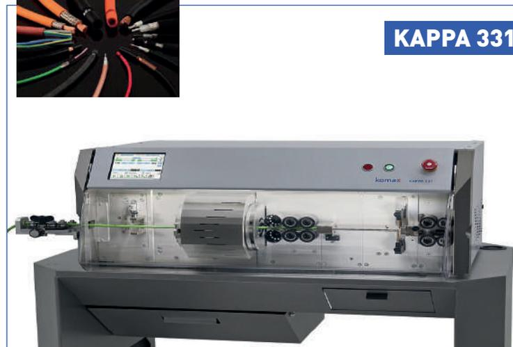
Macchina automatica taglia e spela, modulare con dispositivo di rotazione lame. macchina adatta per cavi multipolari, cavi schermati e cavi coassiali. Kappa 331 lavora cavi da 0.22 a 35mm<sup>2</sup> e con diametro esterno fino a 16mm. La macchina è molto flessibile e di facile utilizzo nella programmazione, grazie al suo sistema TOPWIN su display macchina o PC collegato.
